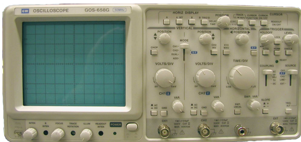
Obrázek 31: Čelní panel osciloskopu GOS 658G.
