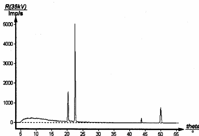
Obr. 2. Spektrum charakteristického rentgenového záření Cu získané užitím LiF monokrystalu.
